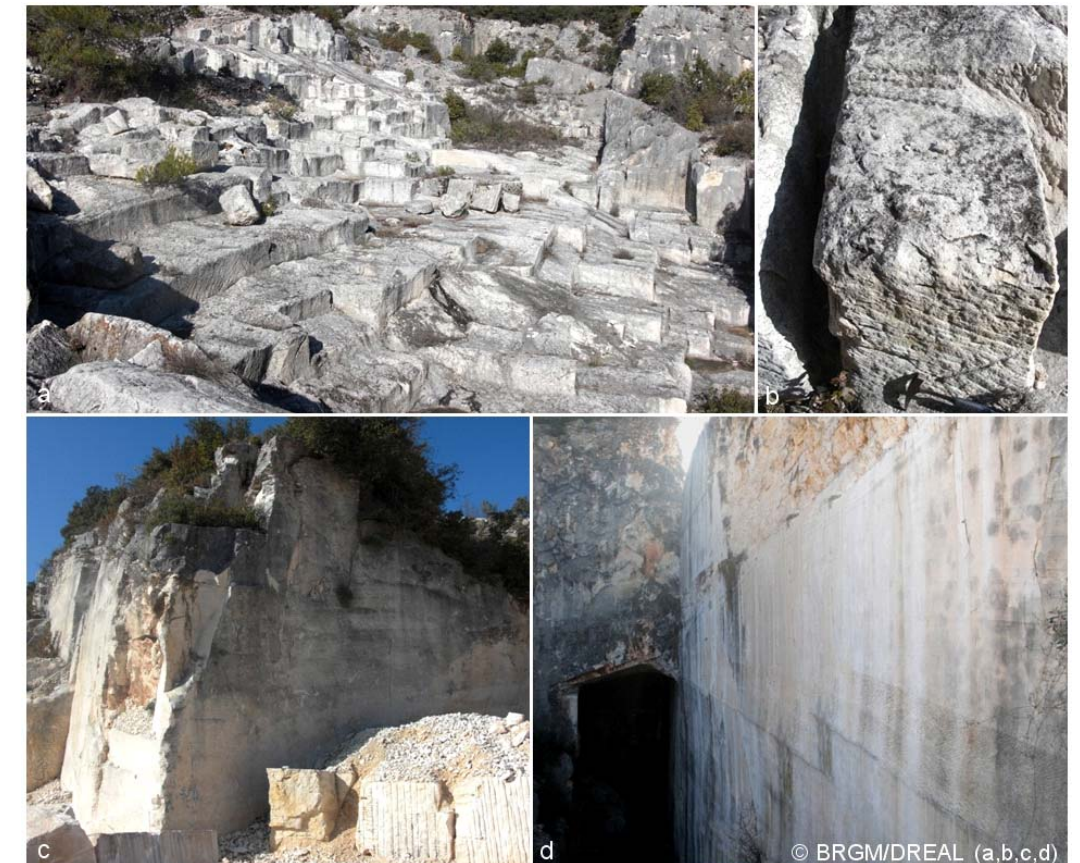
Carrière antique en gradins de Mathieu (a). Traces d'extraction d'un bloc par la méthode romaine (b). Traces d'exploitation ancienne sur le bord de la carrière actuelle de Rocamat (c). Carrière ancienne de Bone (d) (clichés BRGM/DREAL).
