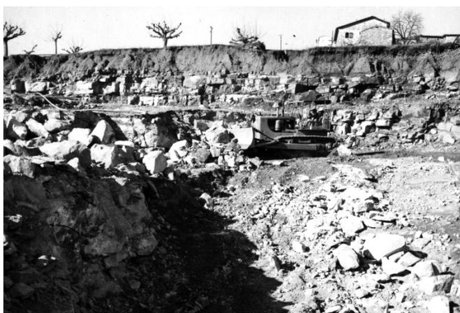
Dégagement du minerai abattu au bulldozer. Remarquer la disparité de taille des blocs dont les plus gros devront être réduits à moins de 800 mm avant transport à la laverie
